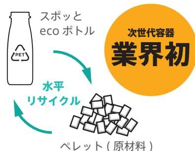
本製品は、分別可能な2重構造技術で、**油性食品容器の水平リサイクル**を可能にします。外容器は中身に触れないので洗浄せずにそのまま回収可能です。
