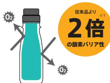
容器の内袋にEVOH層を設けることで、**高い酸素バリア性**を実現しました。従来のPETボトルと比較して、**約2倍のバリア性能**を持ちます。
