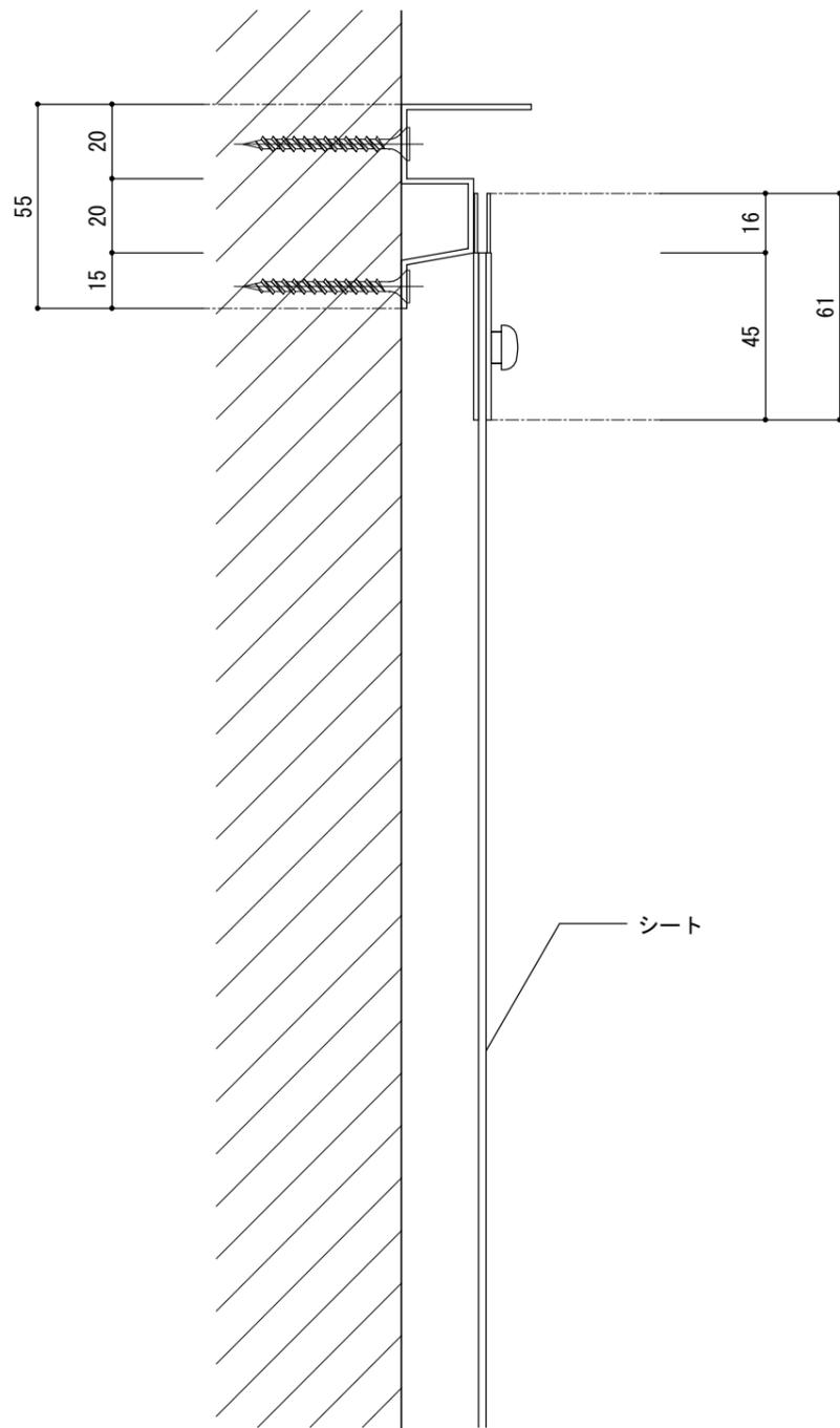
金具断面詳細図 (壁付け) S=1:2
